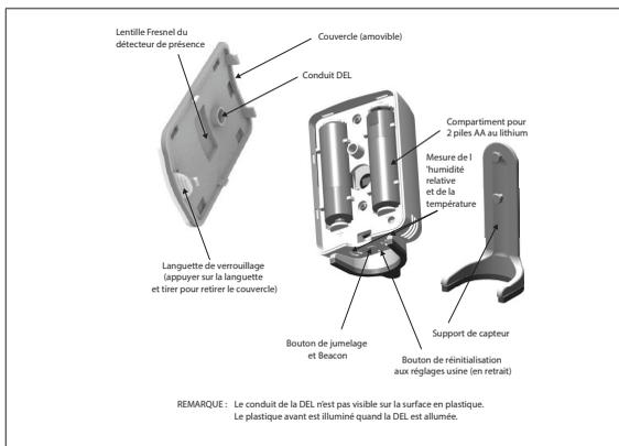
Figure 1. Emplacements de l'indicateur à DEL, des boutons, des événements du capteur et du compartiment des piles
